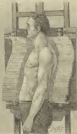
Fig. 1. - Conformador Demeny dispuesto para tomar la sección ó el perfil vertical del cuerpo
